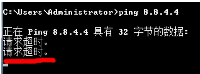
3、检查自身拨号光纤是否中断，输入：ping 180.76.76.76。出现图一数据则说明拨号光纤连接正常；出现图二的数据则说明**拨号光纤连接中断，请向您的拨号光纤提供商报障修复。**
